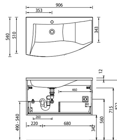
Bei Waschtischanlagen mit Befestigungsschrauben müssen die Maße zum Bohren vor Ort, nach dem Auflegen des Waschtisches auf den Unterschrank, angezeichnet werden.
